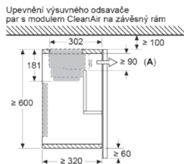
A: výměna filtru
